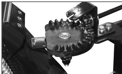
Рис. 33 Механизм поворота желоба ST661
